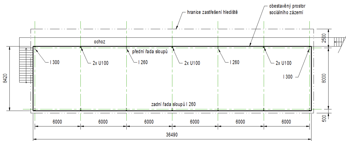
obr. č. 4 – současné profily sloupů nad hledištěm
